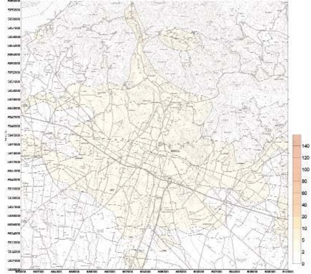
Fig.10 Concentrazione media annuale NO x (µg/m 3 ) attribuita al riscaldamento civile (caldaie di edificio)
